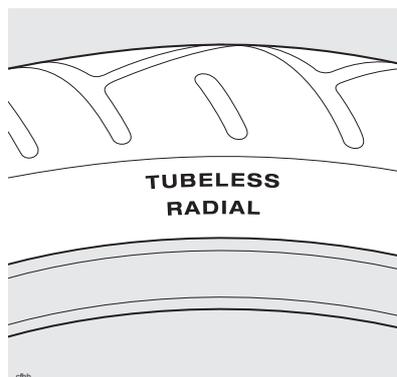
Marcação típica dos pneus - pneu sem câmara
